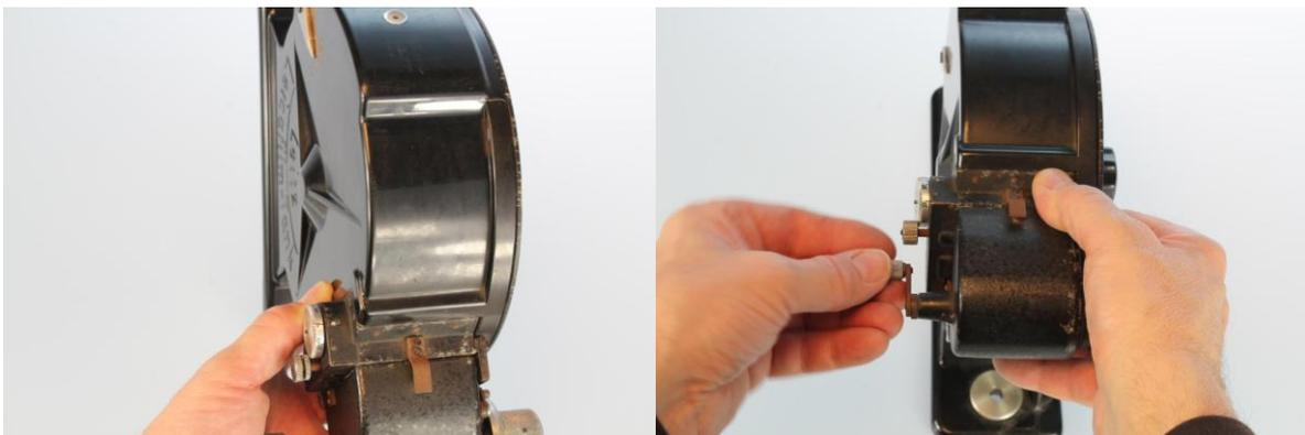
Einspulammer verschlossen und die Scheibe des Zählwerks auf Null gesetzt. Mit der Kurbel kann man nun soviel Film wie gewünscht in die Kassette einspulen. Durch Drehen des großen Knopfes an der Einspulammer wird die Kassette verschlossen und die Abdeckung der Einspulammer entriegelt. Der Knopf federt immer wieder selbsttätig in seine Ausgangstellung zurück.
