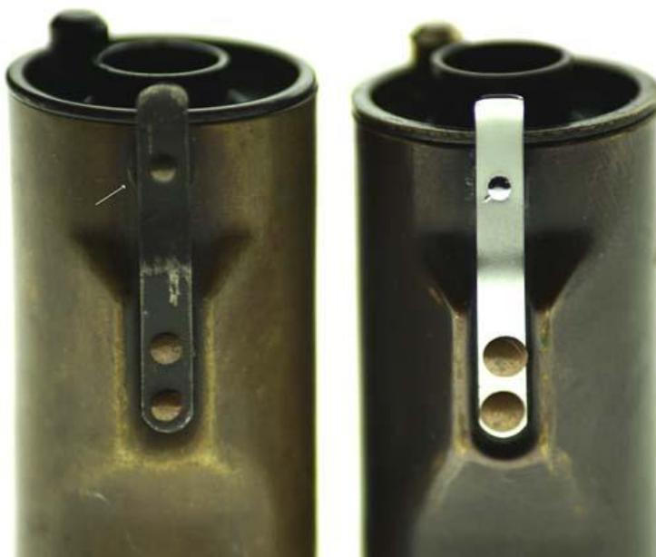
Unterlagscheibe mit Pfeil markiert links bei der B-Kassette
