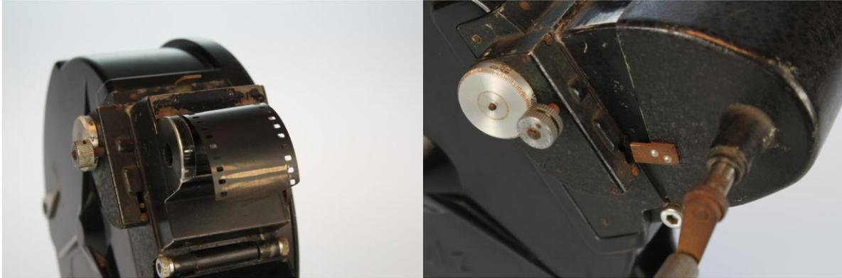
*Film in der Einspulammer Mechanismus für den Lichtverschluss zwischen Einspul- und Vorratskammer, Kurbel zum Einspulen und Zählwerk für den eingespulten Film*
