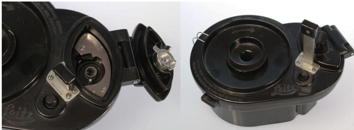
*Geöffnetes Kassettenfach zur Entnahme der Kassette, Entwicklung mit herausgezogenem Messer*
