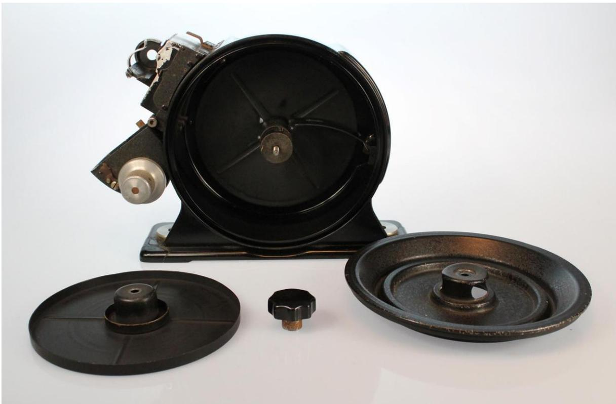
Leicafilm Tank in geöffnetem Zustand, mit Vorratskammer und Einspulkammer
