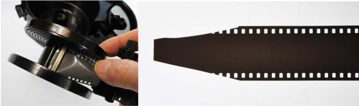
*Film mit Einspulhilfe, Klemmung an die Spiralenachse, optimaler Anschnitt des Anfangs*
