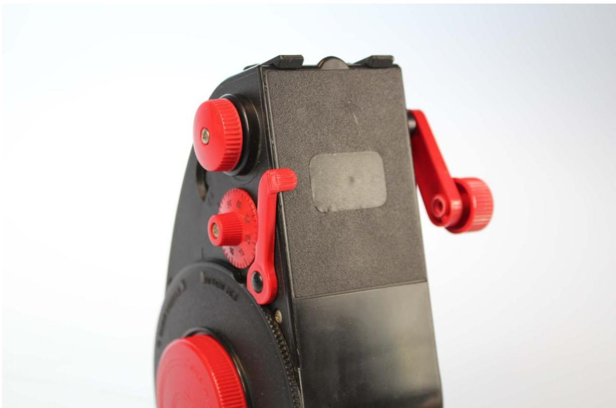
Watson Filmlader, der Hebel steht auf „To Load Film“. Der Schlitz zwischen Vorrats- und Einspulkammer ist offen, gleichzeitig wird der Deckel der Einspulkammer gegen Öffnen blockiert.
