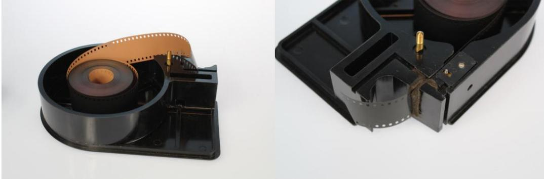
*Einsetzen Rohfilm, Filzmaul und Zahnrad für Zählwerk*
