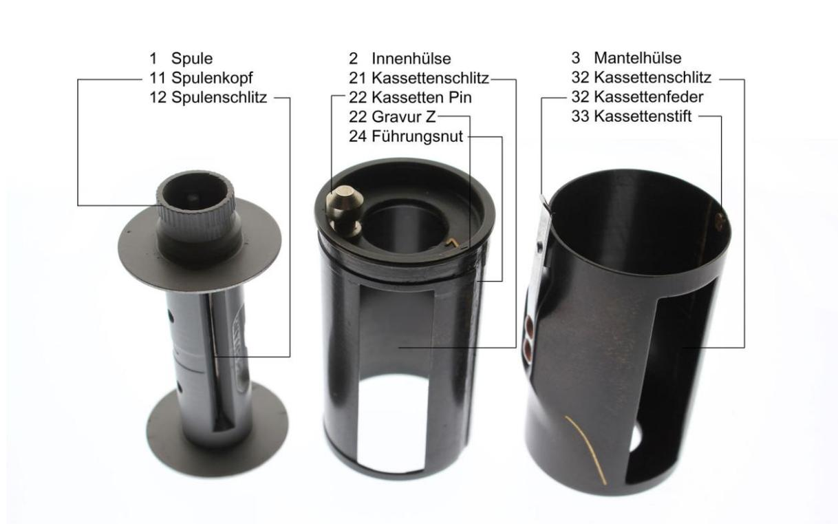
Leica Filmkassette Typ N Einzelteile
