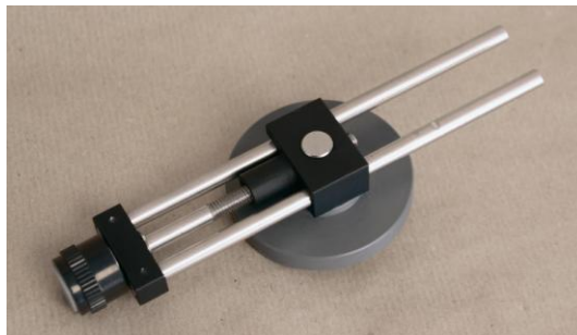
unterer Drehteller mit Feinjustierung
