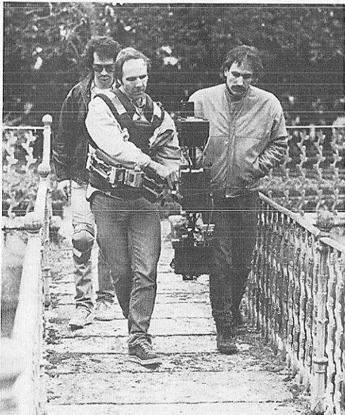
Kameramann Immo Renz vom SWF bei einem Low-Mode-Einsatz mit Steadicam (Modell II) und Arriflex 16 SR.
