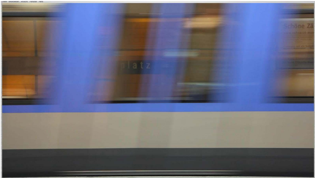
Verzerrungen (Rolling Shutter Effekt) des CMOS Sensors durch zeitlich versetztes vertikales Auslesen
